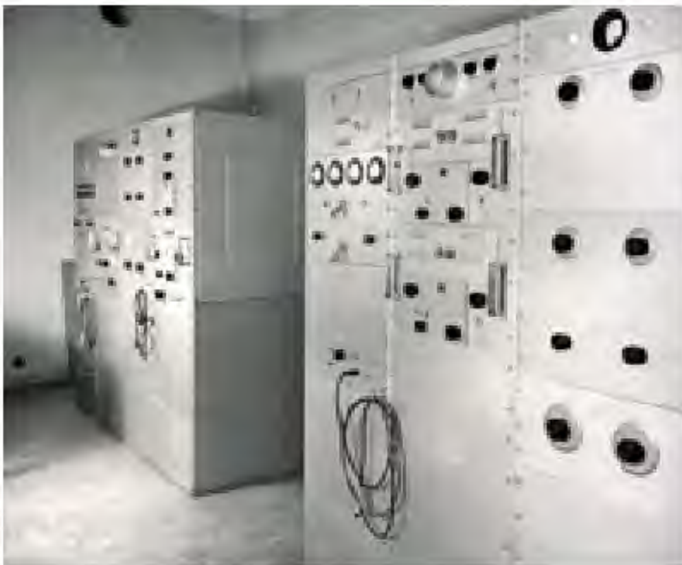
Radiosändare FMR 1 fr v Långvågsdel och Kortvågsdel Sändarnas effektsteg utgjordes av tre Philips PB 3/800 i parallell och gav uteffekten 2,2 kW
